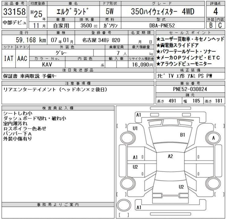
A:キズ U:ヘコミ B:セズを伴うヘコミ P:要塗装 W:補修跡 S:錆 C:腐食、穴 G:フロン物゙ラス点キズ XX:交換済み X:要交換 欠:欠品 内・外装評価 5段階ランク順(A・B・C・D・E) 1
