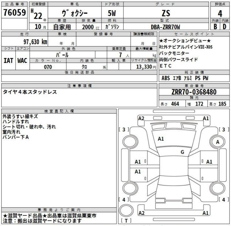
A:キズ U:ヘコミ B:キズを伴うヘコミ P:要塗装 W:補修跡 S:錆 C:腐食 G:フロントガラス点キズ XX:交換済み X:要交換 内・外装評価 5段階ランク順(A・B・C・D・E) 1
