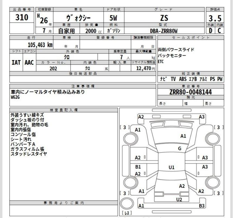
A:キズ U:ヘコミ B:キズを伴うヘコミ P:要塗装 W:補修跡 S:錆 C:腐食 G:フロントガラス点キズ XX:交換済み X:要交換 内・外装評価 5段階ランク順(A・B・C・D・E) 2
