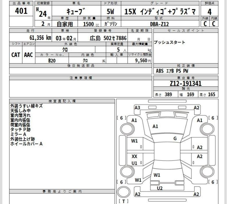
A:キズ U:ヘコミ B:キズを伴うヘコミ P:要塗装 W:補修跡 S:錆 C:腐食 G:アロントガラス点キズ XX:交換済み X:要交換 内・外装評価 5段階ランク順(A・B・C・D・E) 2
