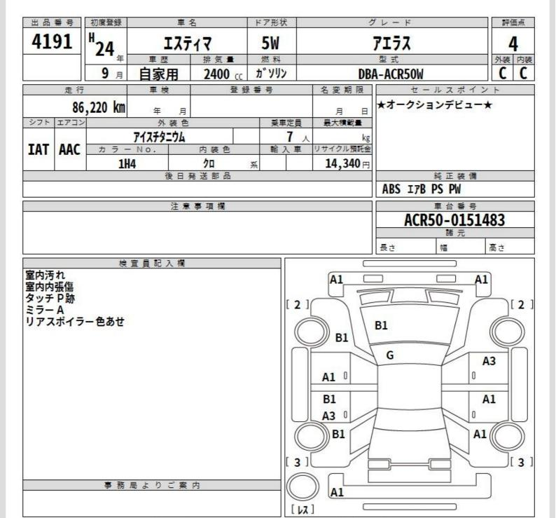
A:キズ U:ヘコミ B:キズを伴うヘコミ P:要塗装 W:補修跡 S:錆 C:腐食 G:アロントガラス点キズ XX:交換済み X:要交換 内・外装評価 5段階ランク順(A・B・C・D・E) 1
